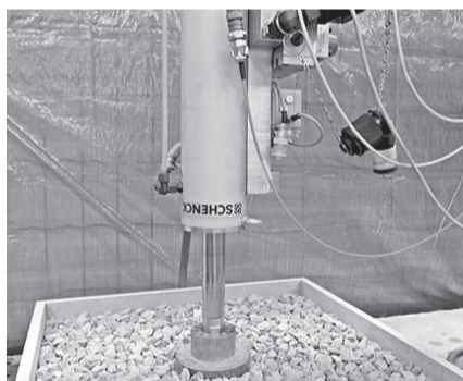
Покрытие способно выдерживать давление в 0,5 тонн без значительного смещения гравия
