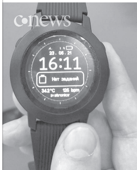
Это умные часы Sitronics. С их помощью прораб может через веб-интерфейс ставить задачи бригадиру, а тот передавать обратно статус выполнения. Бригадир и прораб могут в реальном времени посмотреть, где находятся рабочие. Источник: SNews
