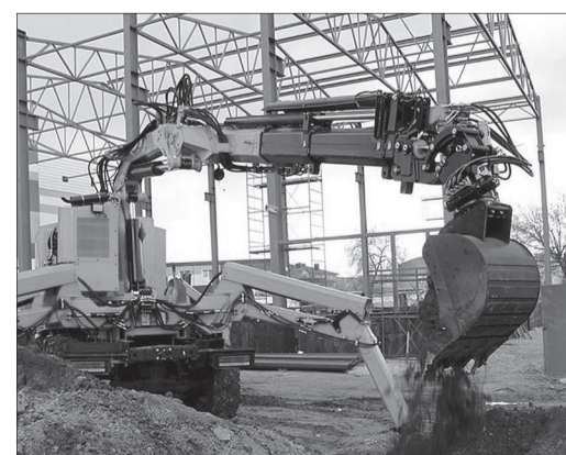
РОИН P-700 — российский робот, который спроектирован для простых работ в опасных для человека условиях. Робот умеет копать, бурить, дробить, перемалывать кусты. Источник: robotrends
