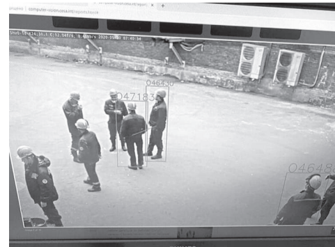
В мае 2020 года, во время локдауна, на череповецкой площадке «Северстали» запустили алгоритм машинного зрения, который вычисляет дистанцию между рабочими на отдыхе. Позднее использование ИИ стало нормой для заводов при контроле за ношением респираторов и других средств индивидуальной защиты. Источник: личная страница гендиректора «Северстали» Евгения Виноградова
